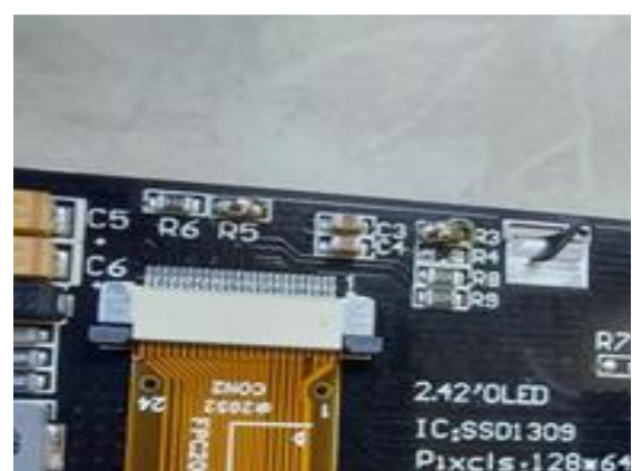
Lötbrücke auf R5 und R3 R4 entfernt
