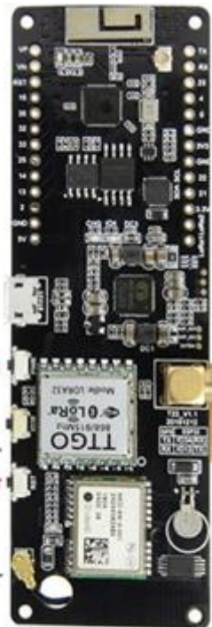
ESP32 TTGO T-Beam V1.1
