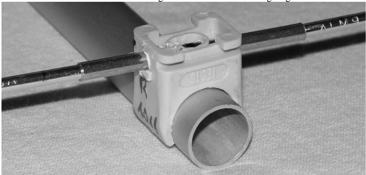
Mittelstück des Reflektors mit der Klemmhalterung und einem 16x1mm-Boom
