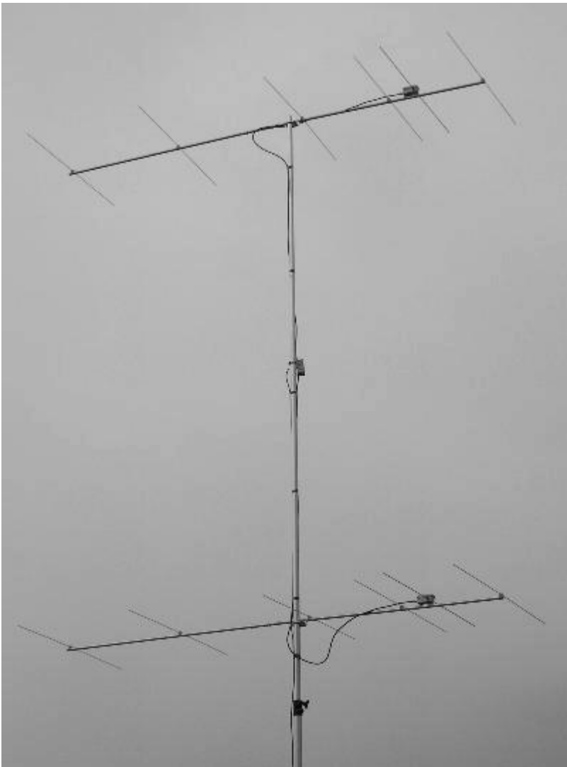
2x 2,50m lange 6-Element-50Ω-2m-Yagis, 13dBd Schmalbandausführung, Stockungsabstand 2,70m
