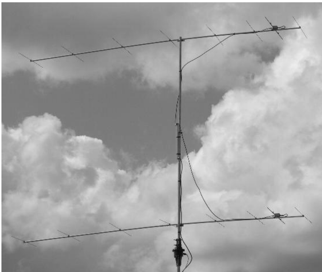
Die gestockte Zweiergruppe aus 8-El.-Yagis mit 20er Boom beim AGCW-Contest Juni 2007
