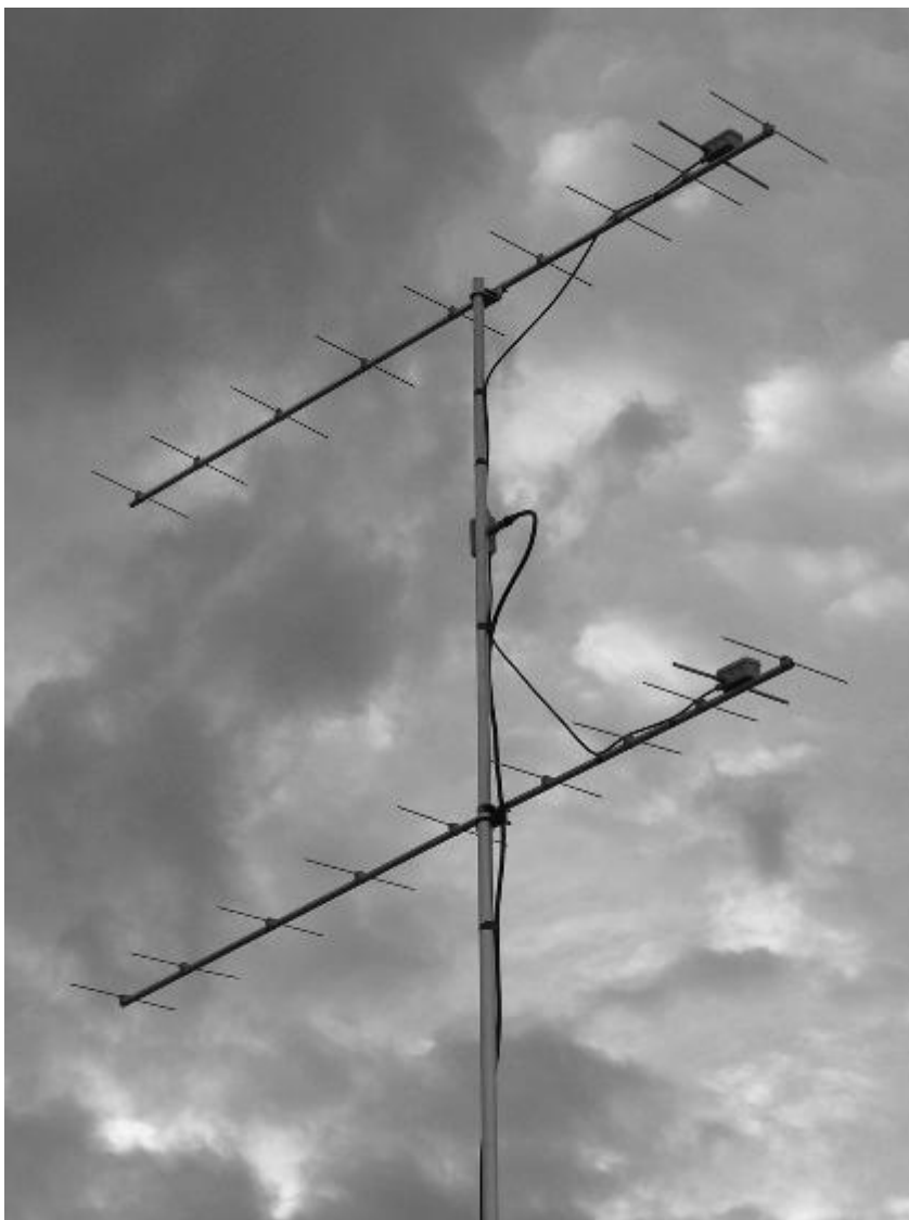
2x10-El.-28Ω-Yagis mit 2m-Boom für 432MHz
