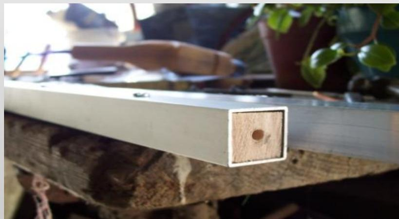
Lo único que se me ocurrió fue introducir una pieza de eucalipto por dentro del boom y sujetarlo a este por tornillos autoroscantes... además a la madera le realicé una perforación para poder unir el boom con el sistema de reflectores dobles usando tornillos tipo soft o estructurales usado para muebles de madera... y al boom de los reflectores le hice un agujero de 8mm
