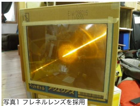
この場合レンズの焦点距離よりLEDの設置点は大幅長くなりますが、LED自身にレンズが装着されているためかどうかまだ確かめていませんが壁に映るLEDの形が一番絞れる所に設定した。尚、焦点距離の調整が出来るように考慮してあります。
