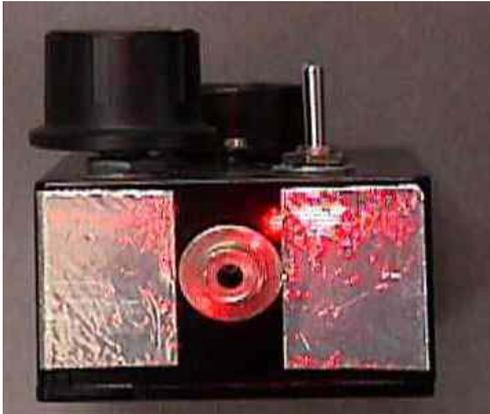
写真6 反射フィルムに映る送信信号
