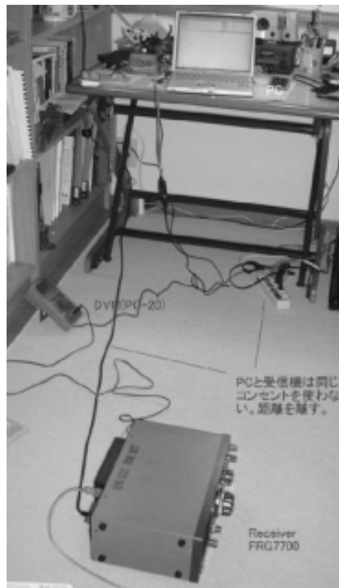
図8：PCからの雑音を最小にするため受信機、テスト、PCを離して設置、測定している室内の様子
