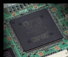
<メインバンド用DSP> ADSP-21369 動作クロック333MHz 32bit浮動小数点 処理能力=2000MFLOPS
