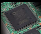
<サブバンド用DSP> ADSP-21375 動作クロック266MHz 32bit浮動小数点 処理能力=1600MFLOPS
