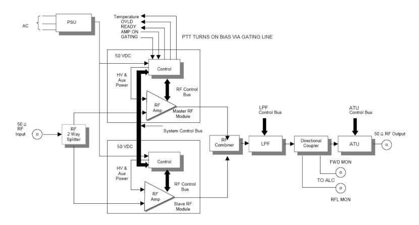
SIMPLIFIED BLOCK DIAGRAM OF TYPICAL SOLID-STATE HF AMP (2 MODULES)
