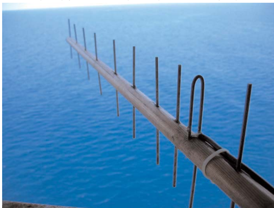
Slika 1. – Yagijeva antena za 900 MHz
