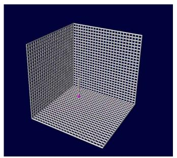
Fig. 1. Original 3D Corner Reflector Antenna.
