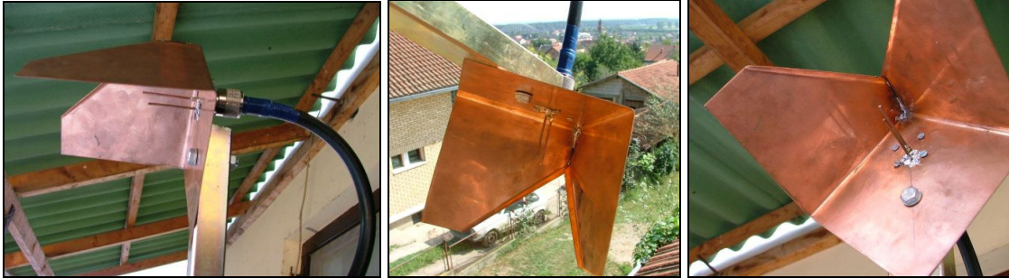
Sl. 20. Izgled montiranog zarubljenog 3D korner fida u fokusu ofset parabole
