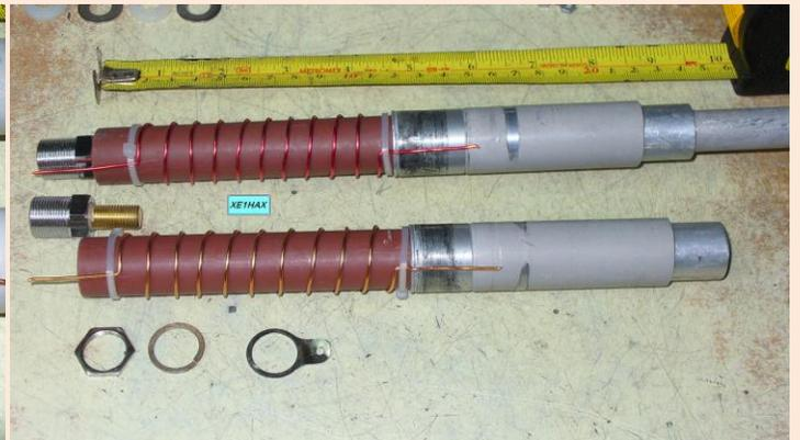
4.- Ensamble de las bobinas y base del radial.
