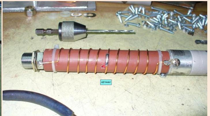
10.- Bobina y conector ya montados y soldados.
