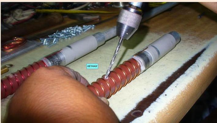
5.- Barrenando para la conexión al conector
