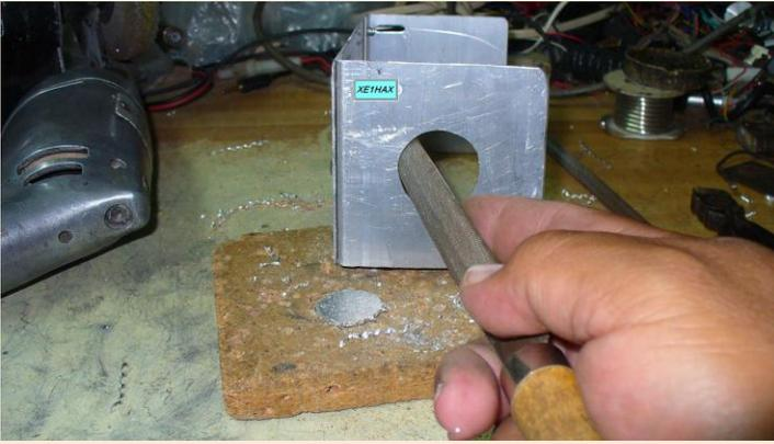
19.- Detallando el barrenado con una lima.
