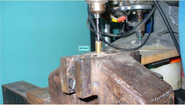
7.- Barrenando el conector para el cable.
