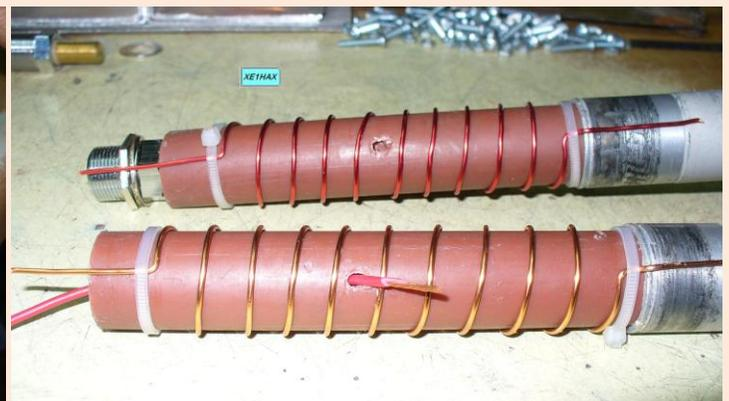
6.- Detalle del cableado al conector.
