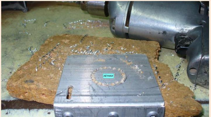
18.- Barrenado lado del radial vertical.
