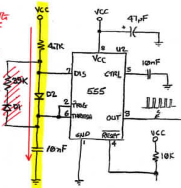
**② ONCE THE VOLTAGE AT THE THRESHOLD - TRIGGER PINS RISES SUFFICIENTLY THE TIMER RESETS AND THE VOLTAGE ON THE 10nF CAP BLEEDS OFF VIA THE TIMER'S DISCHARGE PIN.**
