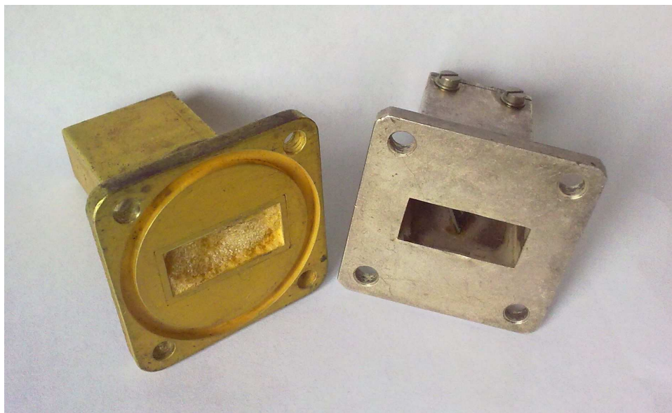
Рис. 8. Волноводные нагрузки WR90.
