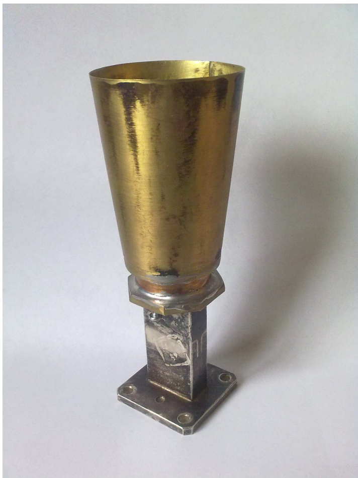
Рис. 7. Рупор Скобелева с волноводным входом WR90.
