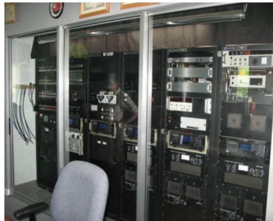
ระบบเครื่องรับส่งวิทยุที่ให้บริการข่าวสาร และการฝึกฝนแก่นักวิทยุสมัครเล่นในสหรัฐอเมริกาและทั่วโลกในย่านความถี่ HF ตั้งแต่ 3.5 MHz จนถึง 50 MHz
