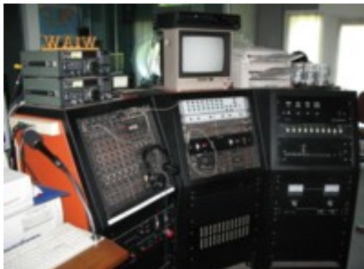
Audio control panel ซึ่งเป็นระบบจัดการส่ง Bulletin และรหัส CW ก่อนที่จะส่งเข้าสู่ระบบเครื่องส่ง
