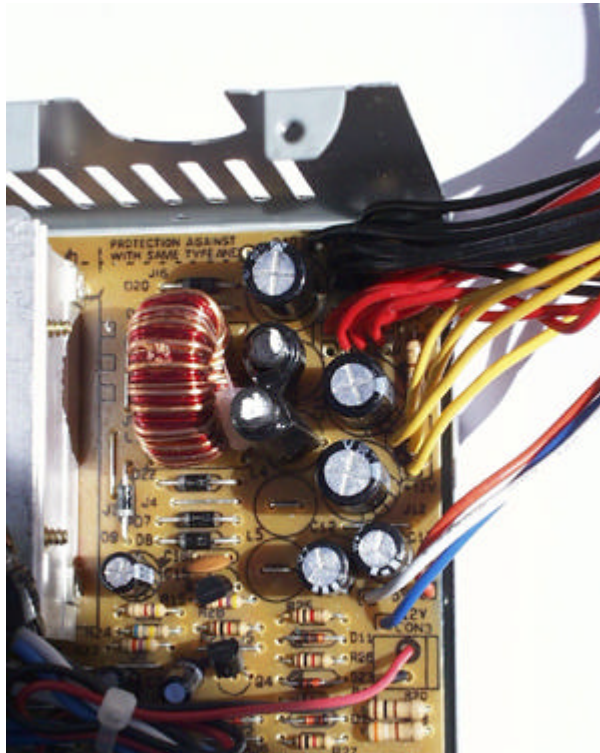
Foto 2 - Antes da retirada dos fios e do indutor
