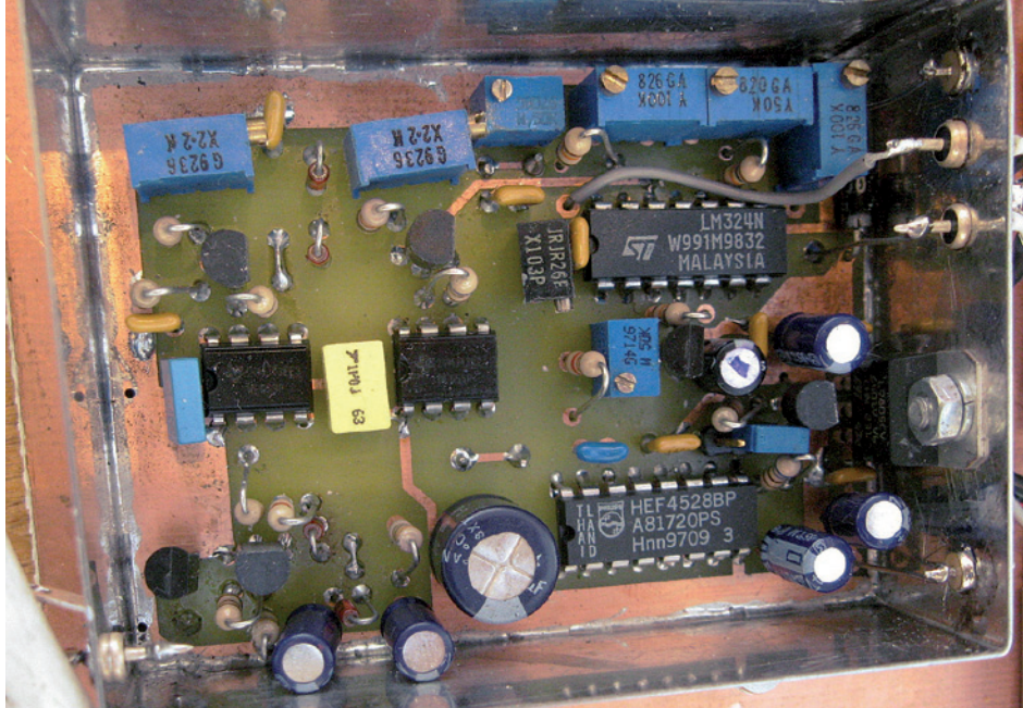
Zicht op het inwendige van de spectrum monitor
