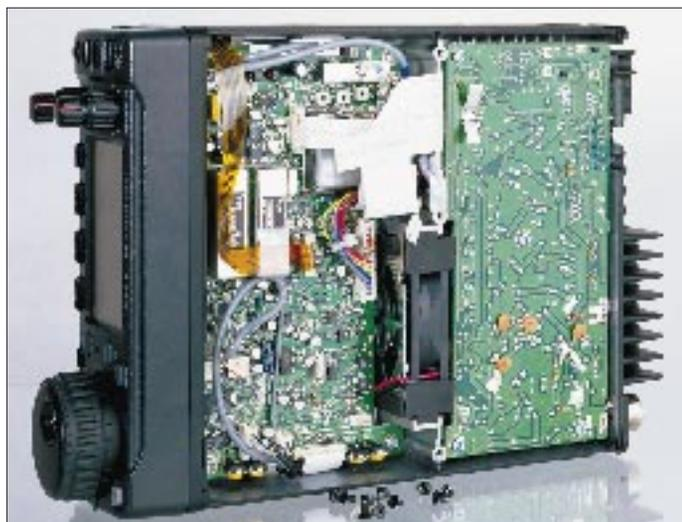
Ein Blick in den oberen Teil des Geräts offenbart die saubere Verarbeitung. Auf der frontseitigen Leiterplatte befinden sich einige Abgleichpunkte.
