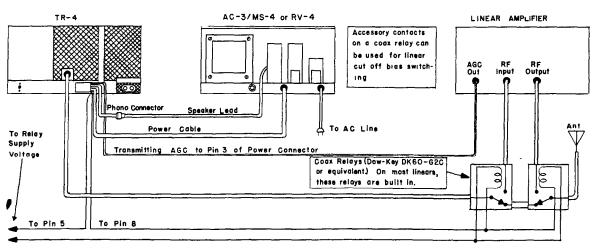
FIG 2 CONNECTING THE TR-4, MS-4, AND AC-3 TO A LINEAR AMPLIFIER
