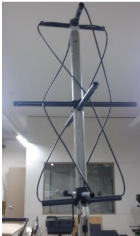
Figura 4.5-4 Antena cuadrifilar helicoidal construida con el diseño de la calculadora de John Coppens.
