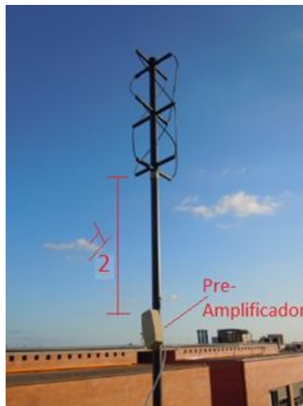
Figura 5-1 Pre-amplificador conectado a \lambda/2 de la antena.
