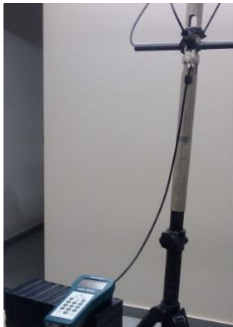
Figura 4.4-5 Conexión entre el analizador de antenas y la antena.
