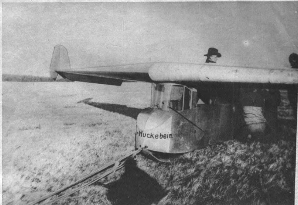
Vorm Start wird noch einmal der Motor gestreichelt — das Sorgenkind Das Startseil zum Traktor ist schon eingehängt.
