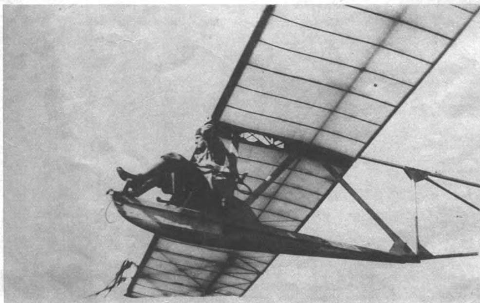
Die Schulmaschine. Auf einem schmalen Brettchen sitzt der Anfänger, in der rechten Hand das Steuer, mit der linken hält er sich an einem Griff an der Tragfläche fest.
