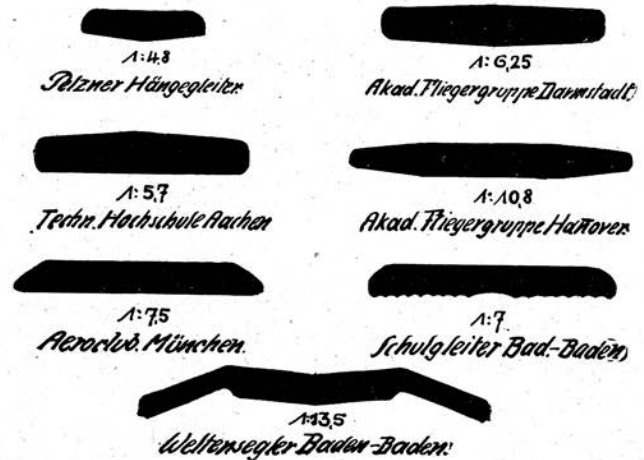
Fig. 16. Zusammenstellung der Flügelformen von bisher gebauten Gleitern und Seglern.
