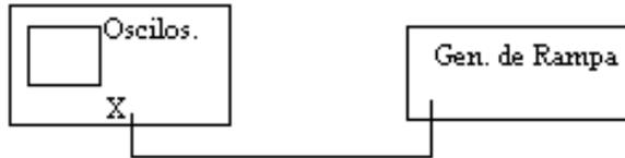
Es una forma muy precaria de medir la linealidad de la rampa , pero si fuera muy mala de esta manera se evidenciaría. Se mide la longitud de la rampa en tiempo, por unidad de incremento, en voltaje.
