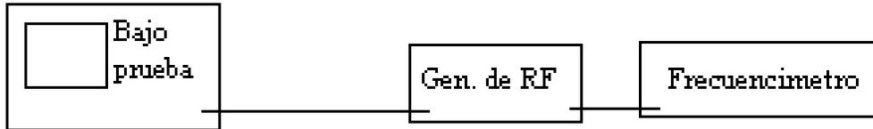
Se trata de obtener el rango de frecuencias que ingresan al instrumento. Para ese fin se trabaja de la siguiente manera :
