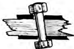
Abb. 76. Bolzenbohrung nicht senkrecht.
