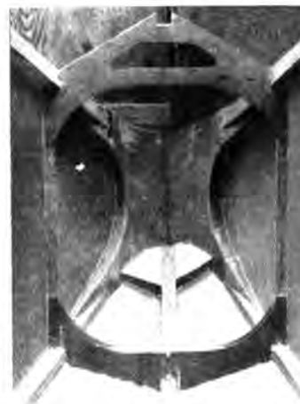
Abb. 71. Rumpfnase aus Sperrholz verleimt.
