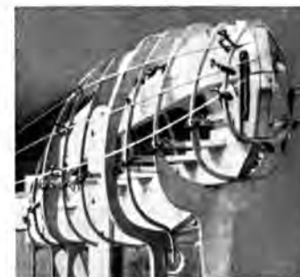
Abb. 117. Ausrichten der Spanten mit dünnen Latten.
