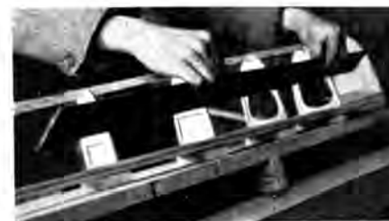
Abb. 101. Ausrichten der Rippen.
