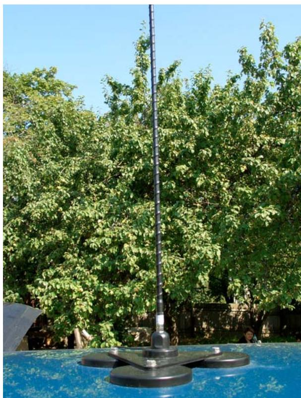
зарекомендовавшая антенна MFJ-1620T. Испытываю сложность с установкой мощной системы магнитов основания антенны. Перепробовав за многие поездки различные варианты антенн (1/4 вертикал, LW, Диполи), по простоте развертывания за определенное время (как норматив какой-то!) при автомобильном варианте, остановился на MA-5 Kenwood и MFJ-1620T.
