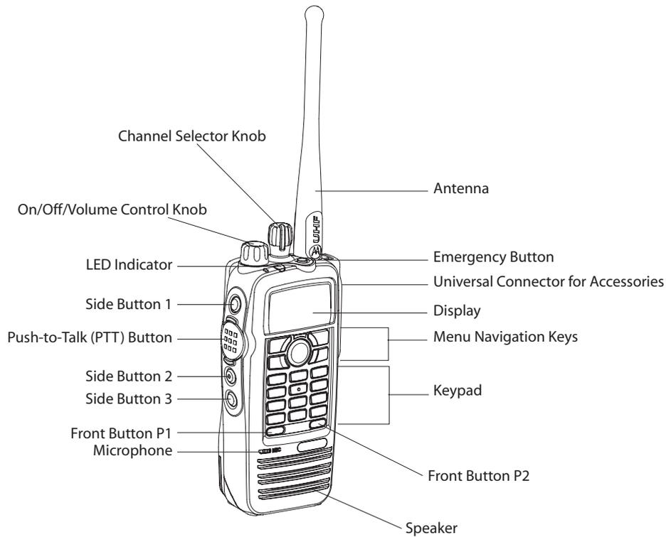
Figure 3-2 MOTOTRBO Portable (Display Model)
