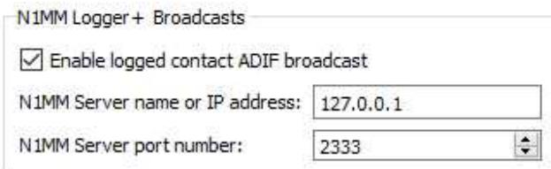
N1MM Logger+側では、Config|Configure Ports,...|Broadcast Dataと進み、画面下方のWSJTとJTAlert connectionsをチェックしておかなければなりません。
