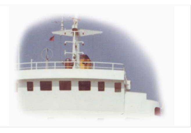
Quelle piu' recenti degli anni 60, hanno due radar, ma uno era perennemente in avaria. (in genere era quello in banda S, in quanto avendo l'antenna molto grossa era soggetto ad avarie meccaniche sull'asse del motore di rotazione). Mentre quello in banda X funzionava bene ma solo sulle portate inferiori alle 24
