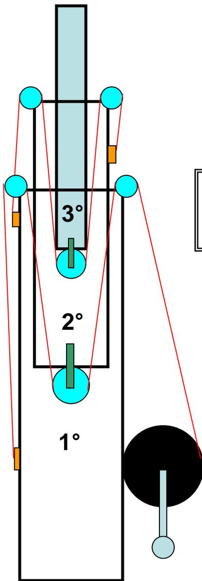
■ Punti di fissaggio cavo
