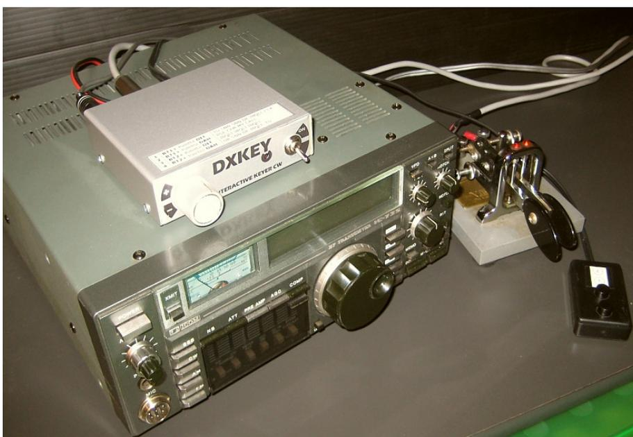
jambic, e così l'attacco a jack accettava solo i tasti verticali: per l'electronic key la ICOM raccomandava infatti l'installazione della scheda aggiuntiva EX243, che si doveva comprare a parte (foto 3).
