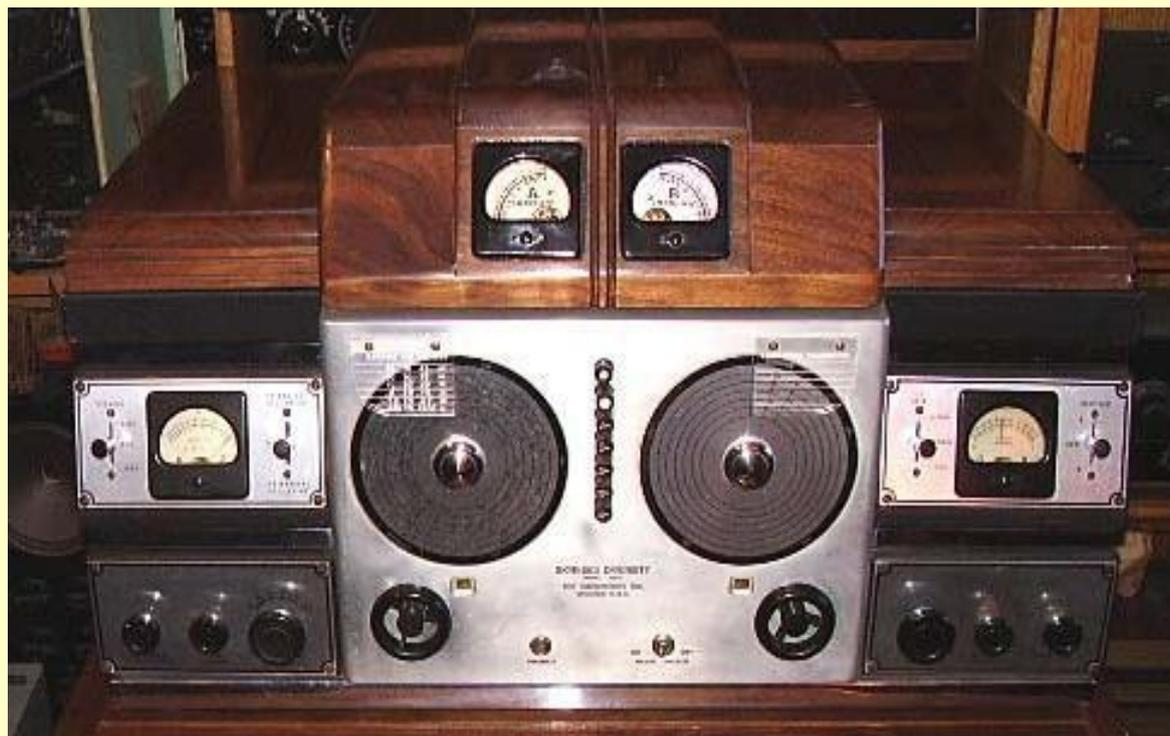
Qualcuno di noi ha provato ad impiegare due ricevitori su antenna diverse per ricevere gli stessi segnali in SSB o CW.
