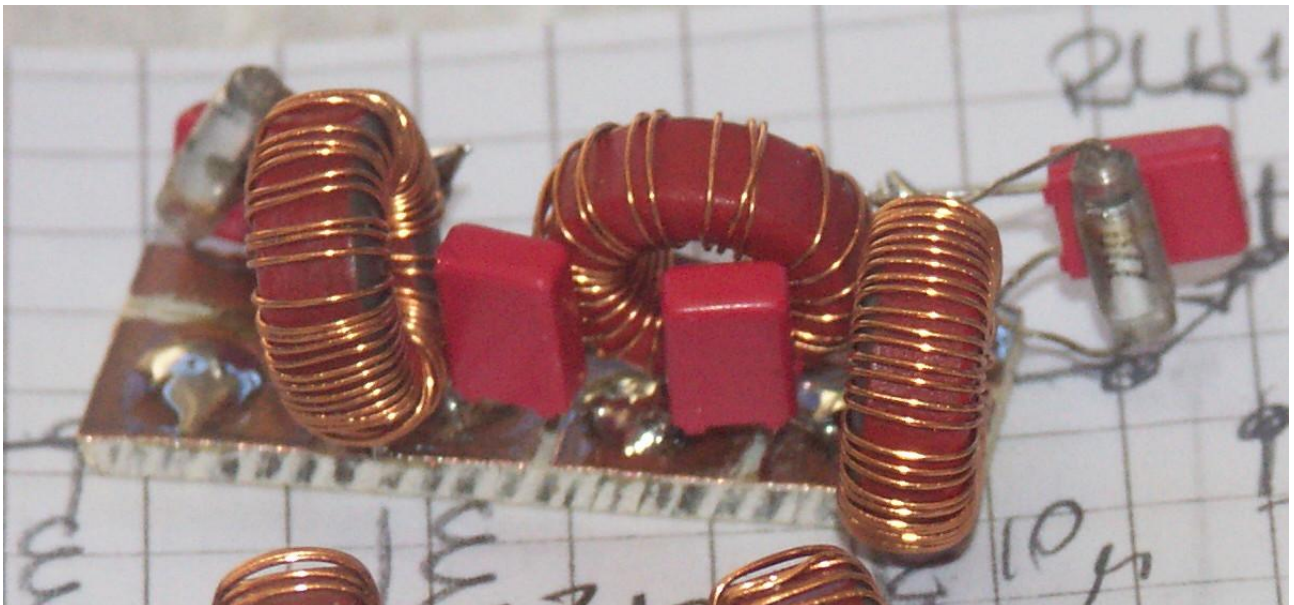
Figura 5 – Vista del Filtro Passa Alto assemblato su una basetta da PCB con aree di saldatura effettuate con taglio manuale della superficie ramata.
