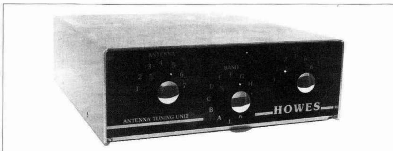
potencial de RF. Una vez terminada la construcción, el módulo debe instalarse en una caja metálica y los ejes de CV1 y CV2 deben quedar aislados de los botones de mando con prolongadores aislantes de plástico (incluidos en el kit).
