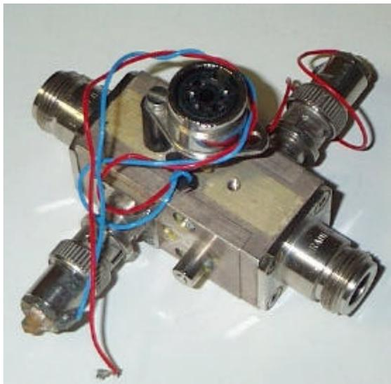
Ein anderes Beispiel ist der bislang bei meinem DJ9BV-Wattmeter eingesetzte Richtkoppler der Firma EME:
