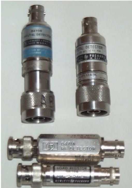
Abbildung 15: Beispiele kommerzieller Diodendetektoren
