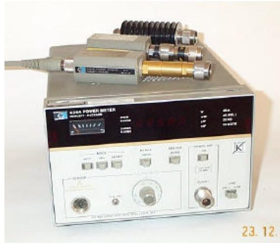
Abbildung 2: HP436 Power Meter mit Zubehör
