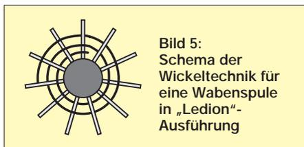
Bild 5: Schema der Wickeltechnik für eine Wabenspule in „Ledion“-Ausführung
