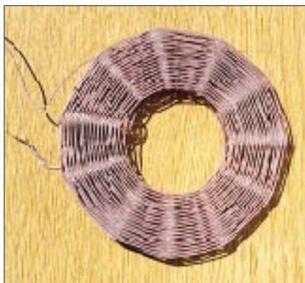
Bild 6: Selbstgewickelte Wabenspule
