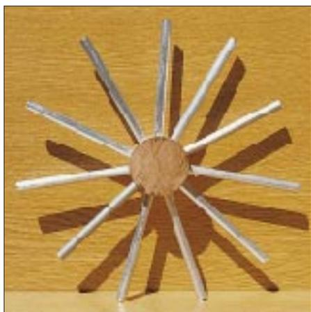
Bild 4: Mittelstück („Spinne“) zum Herstellen der Wabenspulen
