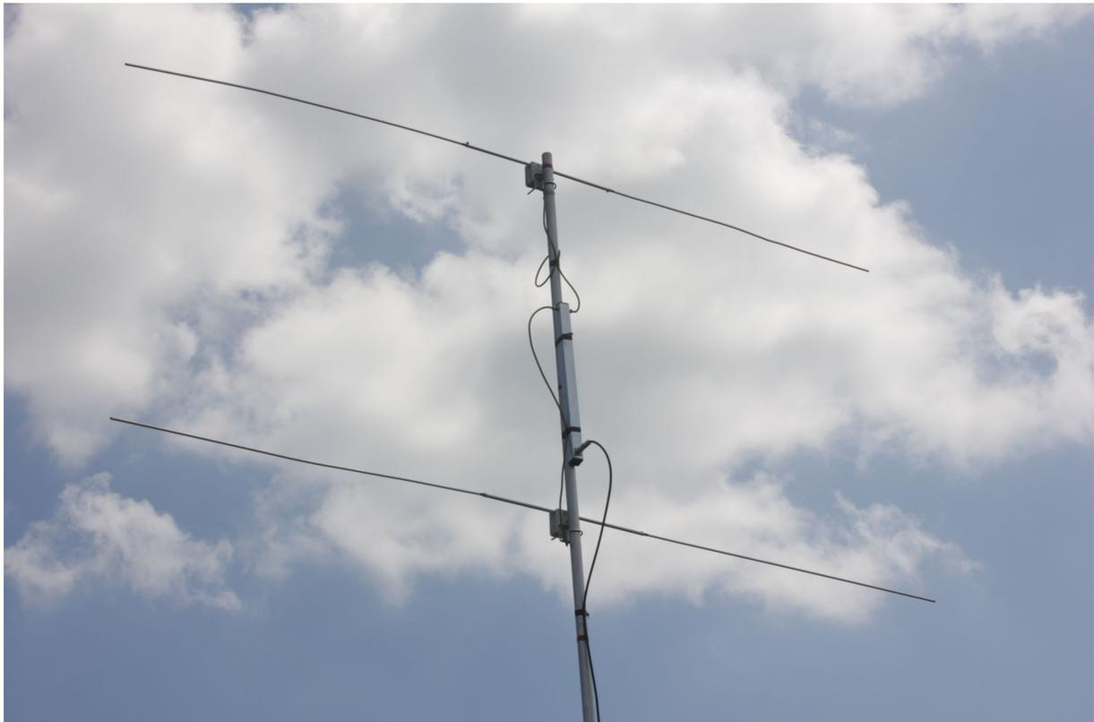
Interessant wird die Sache, wenn zwei solcher Dipole gestockt eingesetzt werden (**Bild 3**). Der Antennengewinn steigt für die Hauptkeulen bei gleichem Azimutdiagramm auf 5,6 dBd und die Impedanz sinkt auf  $74 \Omega$ , wenn der optimale Stockungsabstand von 1700 mm eingehalten wird. Dieser sollte auf jeden Fall stimmen, weil er nicht nur den Gewinn beeinflusst. Auch die Impedanz und die Länge der Einzeldipole hängen vom Abstand ab.
