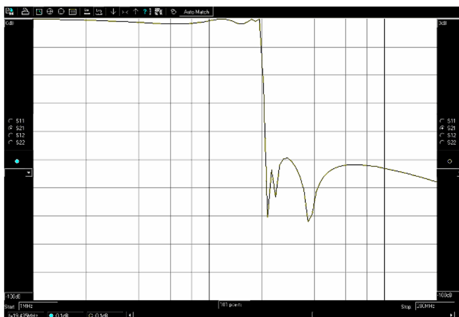
Abbildung 7-5: Simuliertes S21 des sich an den DDS anschließenden Tiefpassfilters
