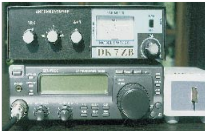
Bild 3: Vorderansicht des fertigen Geräts auf dem TS-50S
