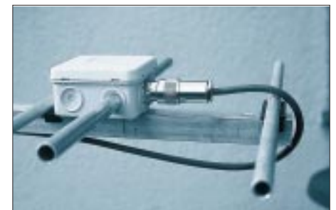
Bild 8: Das Erregerzentrum der 28- \Omega -Yagis für das 70-cm-Band
