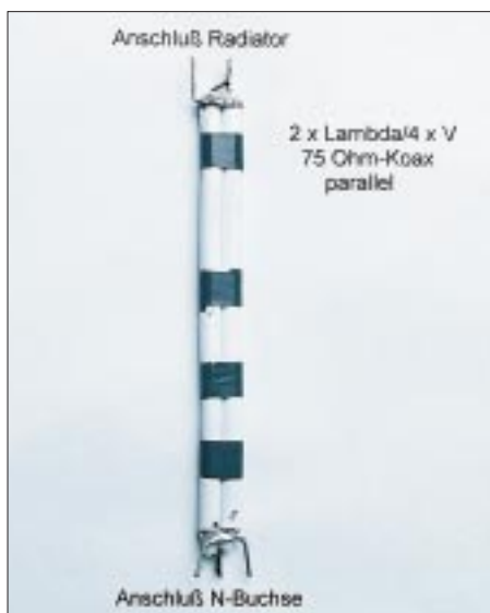
Bild 7: Fertige Anpassungsleitung vor dem Einbau
