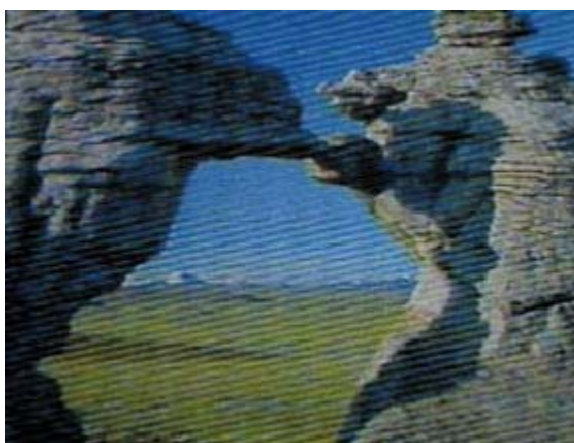
Interferencia causada por un transmisor de radio (Canales de Cable 17 al 22)
