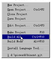
11, 在这里 MPLAB 调用 MPASMWIN.EXE 编译程序对这个项目的所有源程序进行编译 (一个项目可能不只一个源程序),并输出编译结果如下,这里说明了编译器的参数和结果。可能会不通过,出错误,根据这个窗口指出的错误,修改源程序,并再次操作第 10 步
